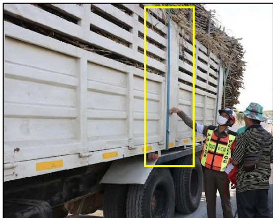
ภาพที่ 2.2-33 สายรัดป้องกันอ้อยหกหล่น
