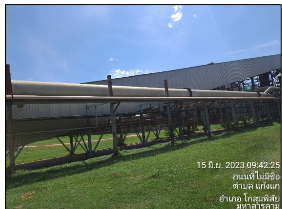
ภาพที่ 2.2-9 ระบบสายพานลำเลียงแบบปิด
